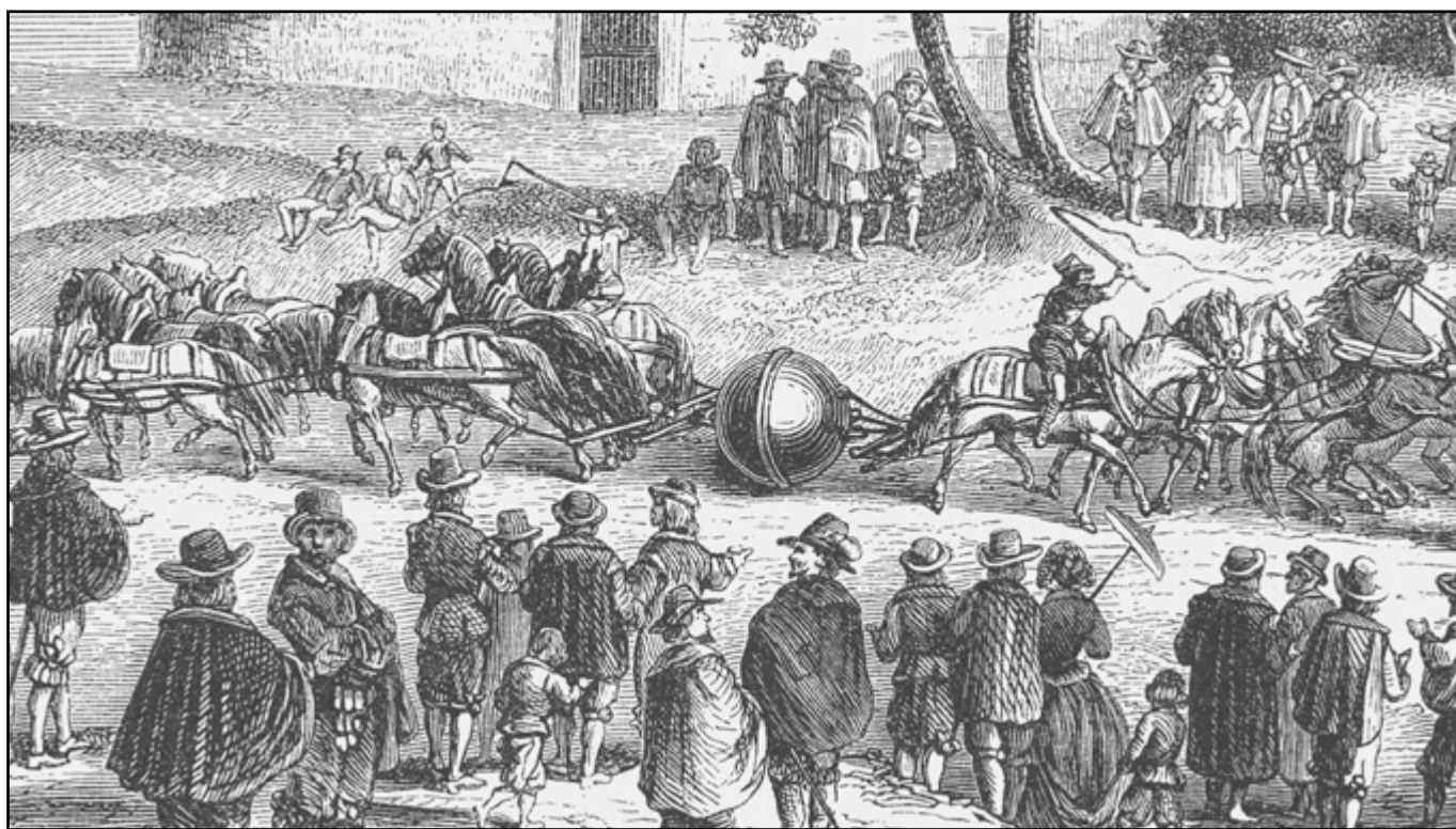
Эксперимент «Магдебургские полушария» Отто фон Герике, 1657 год. С помощью насоса из шара был выкачан воздух, т.е. внутри шара теперь отсутствовало атмосферное давление (вакуум). Внешнее атмосферное давление настолько сильно сжимало оба полушария, что их не удалось разъединить даже под воздействием силы тяги 16 лошадей.
